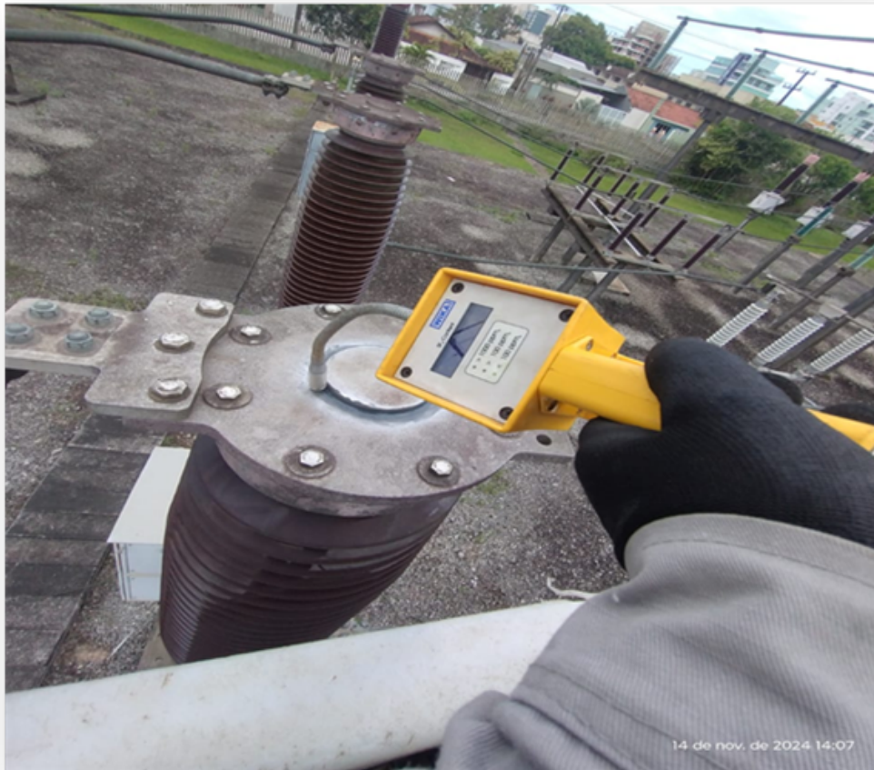
Figura 4. Determinação do ponto de vazamento do Disjuntor 01.
