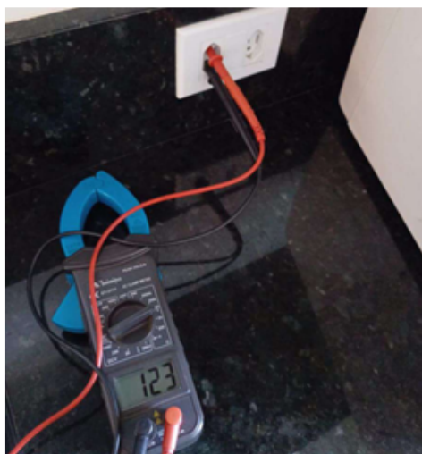
Figura 8 – Aferição dos níveis de tensão da unidade consumidora.
