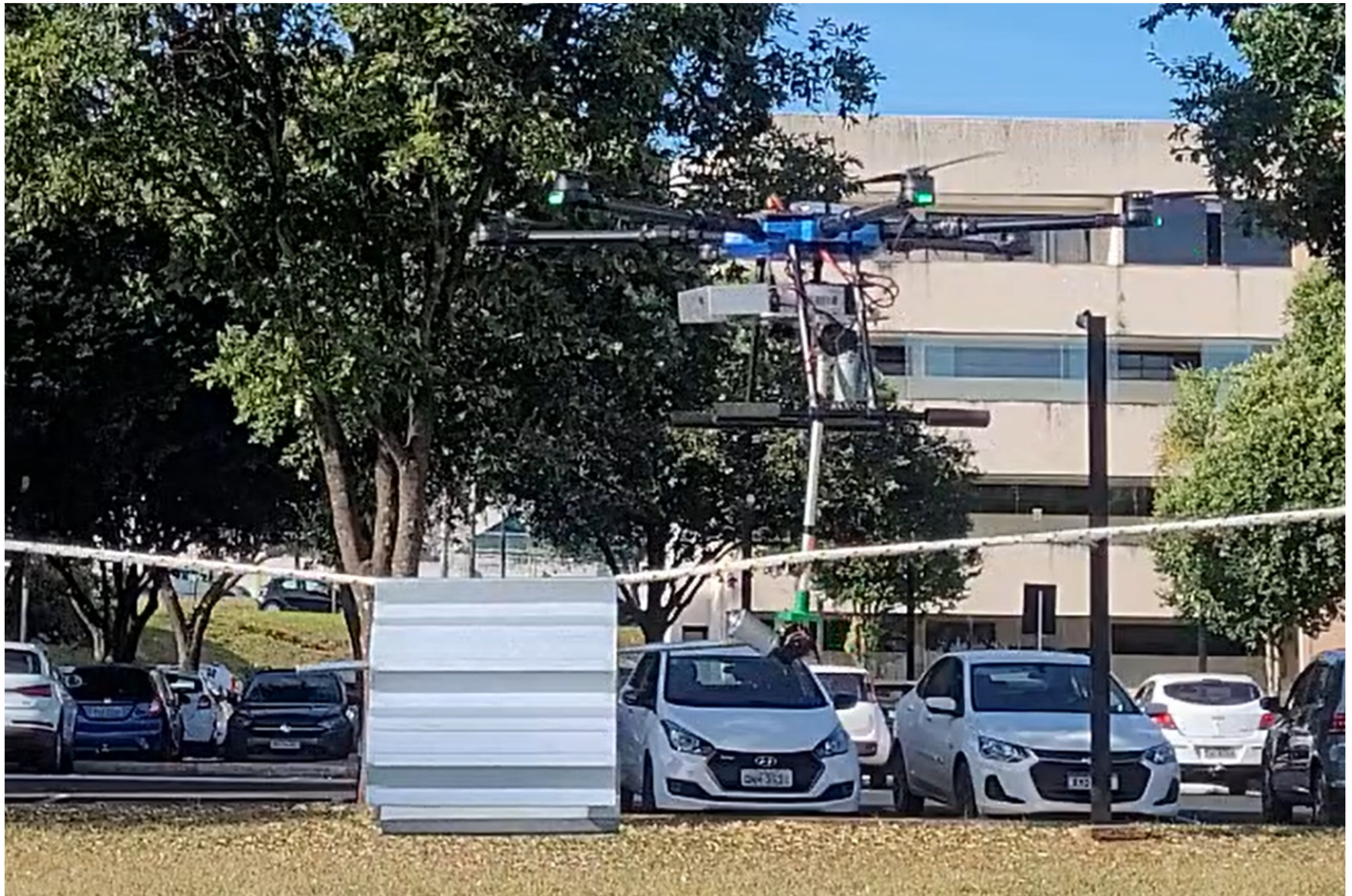
Figura 11. Teste experimental com o drone eletricista para retirada de detrito simulado.
