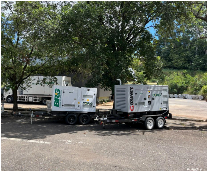
Figura 01 - Geradores de Baixa Tensão modelo reboque - CEMIG
